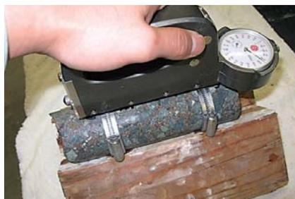
ASR 残存膨張量測定
